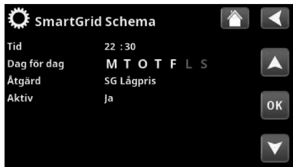
SmartGrid-funktionen "SG Lågpris" schemaläggs vardagar kl. 22.30-06.00. Gå till menyn genom att välja "SmartGrid Schema" i meny "Avancerat/Inställningar".
