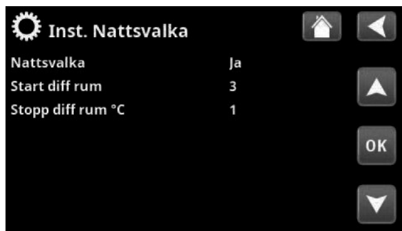
Meny "Avancerat/Inställningar/Inst. Ventilation/ Inst. Nattsvalka".
